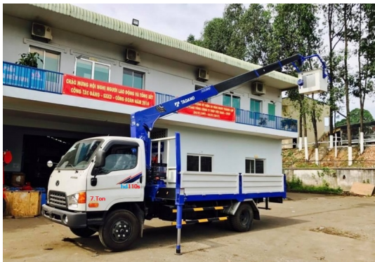
Hyundai 110s gắn cầu unic 340 3 tấn 4 khúc , tải trong 7 tấn hoặc tadano.
